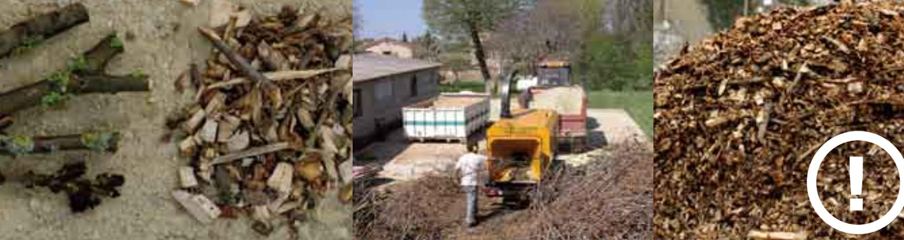
Le même matériel peut souvent être utilisé à différentes fins. De nombreux broyeurs permettent de réduire en copeaux autant des rameaux d'un diamètre inférieur à 7 cm pour du BRF que des branches plus grosses pour des plaquettes de bois-énergie.
